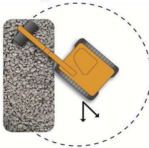
3. kép: kotró mozgási iránya terítés közben
