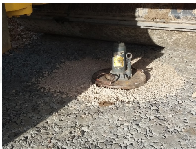
9: fracții fine standard așternute sub placă
