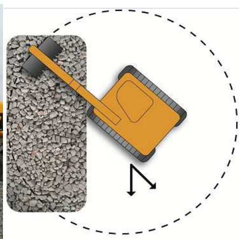
4: direcția mișcărilor executate de buldozer în timpul așternerii
