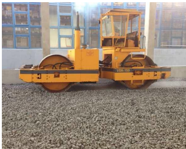
Diagrama 12: compactare cu cilindru vibrocompactor dublu de 15 tone Hala de depozitare Hungaropharma din Debrecen
