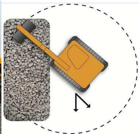
Diagrama 11: direcția de mișcare a excavatorului în timpul așternerii
