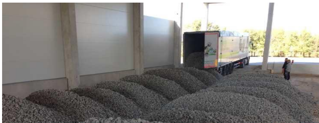
Diagrama 7: descărcare din camion cu podea mobilă (hala de depozitare Hungaropharma, Debrecen)
