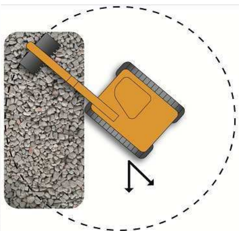
11. ábra: kotrómozgási iránya terítés közben
