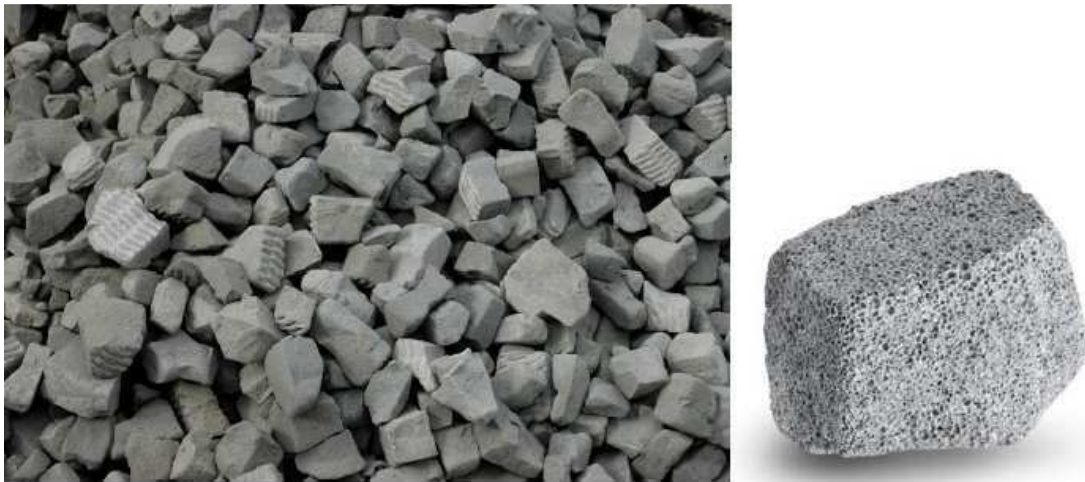
1. ábra Üveghab granulátum halmaz és szemcse
